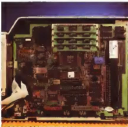
Vista interna. La scheda madre del Key-Comp con al suo lato la zona riservata ai SIMM fino a 16Mbyte nella versione KC-320 e il socket per il connettore multimediale. Come sempre i terminatori sulle tracce passano sovrastare le zone dedicate alle due macchine da 640x480 a tutte le altre, quella per le due slot di espansione con la PCV-401P già installata.
